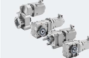
I SIMOTICS S-1FG1 sono servomotoriduttori, forniti come gruppo completo già montato, con il riduttore riempito di olio. La gamma di modelli comprende motoriduttori coassiali, piatti ad assi paralleli, conici e a vite senza fine disponibili, in base al tipo di riduttore ed alla grandezza costruttiva, con fino a 25 rapporti di riduzione.
