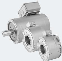
I motori Torque SIMOTICS T-1FW3 completi sono motori sincroni ad elevato numero di poli, con eccitazione a magneti permanenti e raffreddati ad acqua. La gamma dei motori 1FW3 comprende 3 diametri esterni con diverse lunghezze d'asse, nonché 3 diverse esecuzioni dell'albero (albero cavo, albero ad innesto ed albero pieno).
