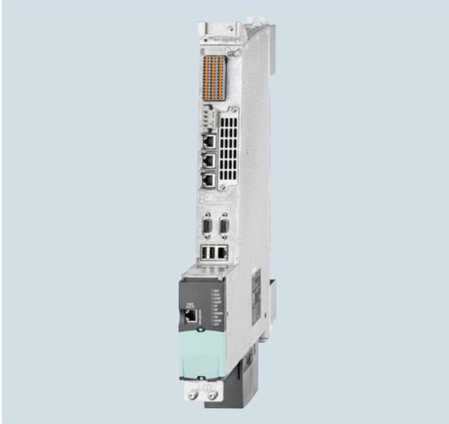
SIMOTION D4x5-2 è la Control Unit basata su azionamento per sistemi multiasse. Le singole varianti differiscono principalmente per le performance di PLC e Motion Control, capacità di memoria e interfacce. Le caratteristiche distintive sono:
